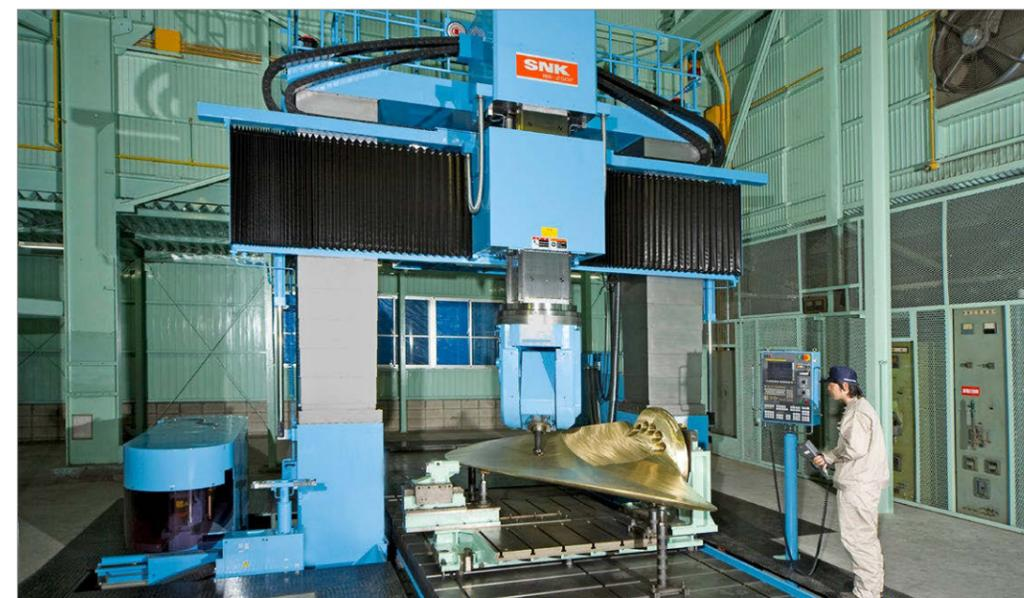
新たに導入した可変ピッチプロペラ用翼面加工機
