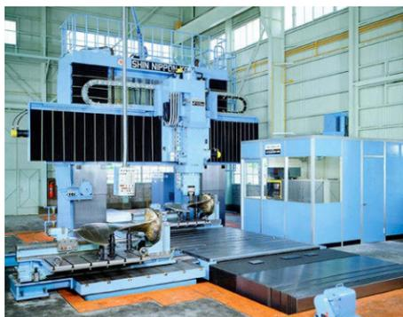
5軸可変ピッチプロペラ用翼面加工機
