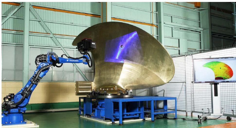
非接触3次元自動計測システム
