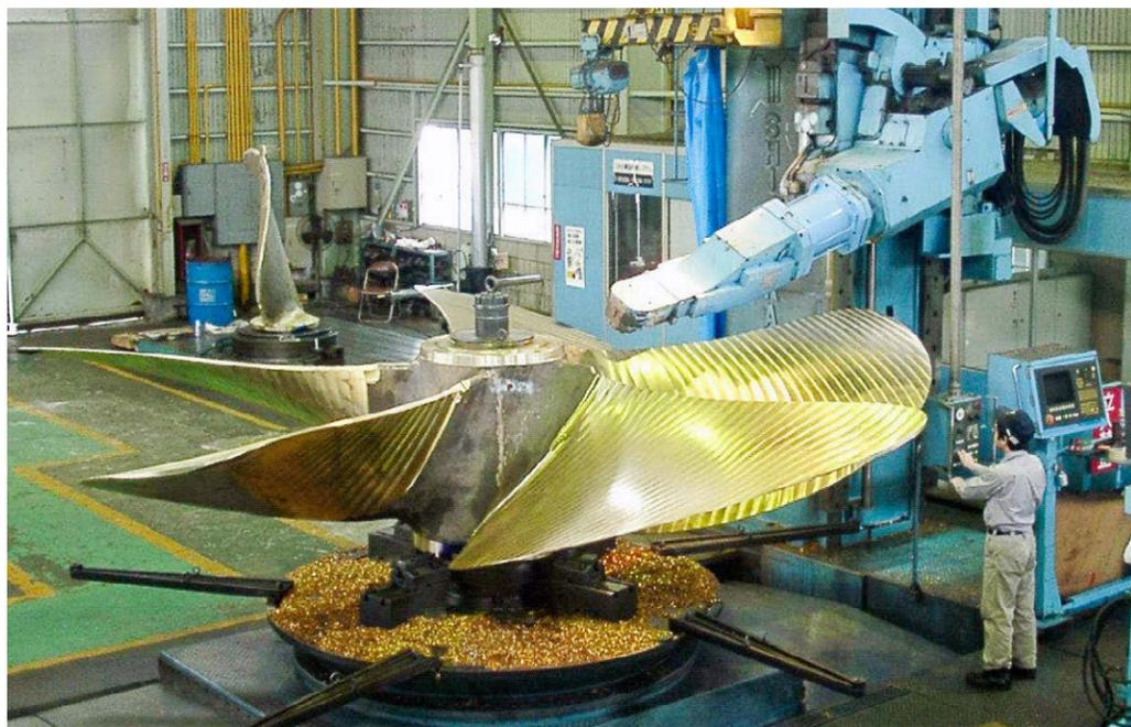
固定ピッチプロペラ用翼面加工機
