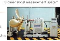
3次元翼面計測システム
