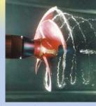
キャビテーション試験 Cavitation test
