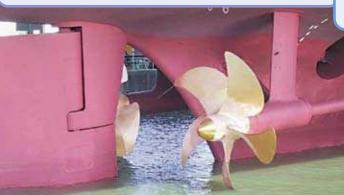
主機関からプロペラ動力を伝達する船尾軸系装置は、船の大動脈ともいう部分で最も信頼性が要求されます。かもめの経験豊かな、確実な設計、検査により製作される中間軸、同軸受け、船尾管等は安全航海に欠かせぬものとしてご採用頂いております。
